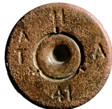
Abb. 7: Bodenstempel «A» auf 10 Uhr gibt an, dass diese Hülse aus rezykliertem Metall hergestellt wurde.
